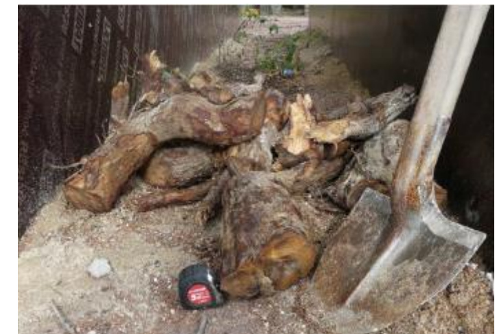
Figure 27 – Racines mises en évidence dans la fouille RF1 (photographie issue du rapport de GINGER CEBTP)
